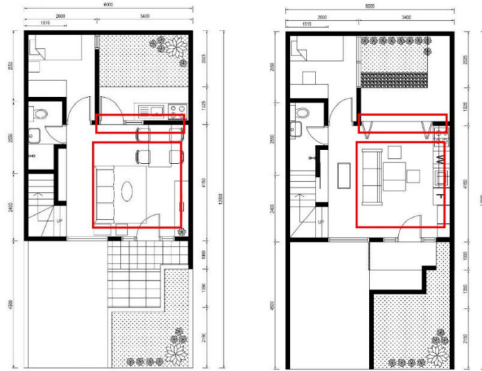
Gambar IV.4: Ilustrasi sebelum dan sesudah penataan layout dan bukaan jendela lantai 1 Sumber: Wulandari (2021)
