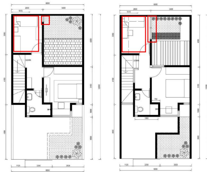
Gambar IV.5: Ilustrasi sebelum dan sesudah penataan layout dan bukaan jendela lantai 2 Sumber: Wulandari (2021)
