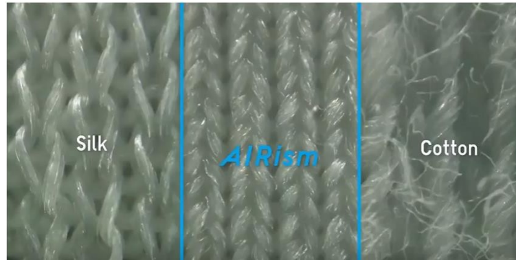
Gambar 4. Perbandingan penampang tekstur kain sutera, AIRism , dan katun
